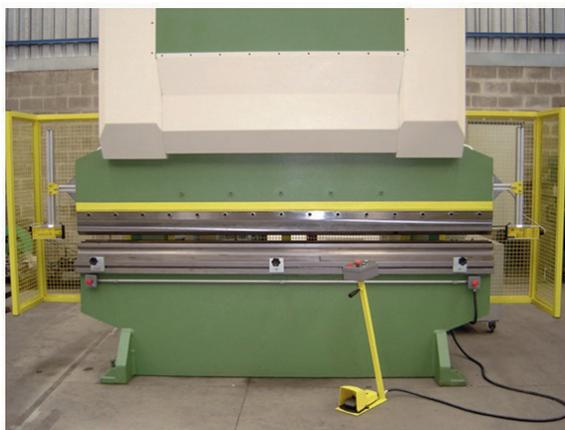
Figura 177 – Dobradeira mecânica transformada em dobradeira hidráulica.
